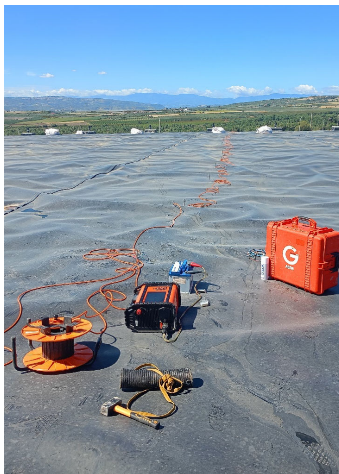
Fig. 1) Acquisizione dati con georesistivimetro Abem Terrameter LS2
